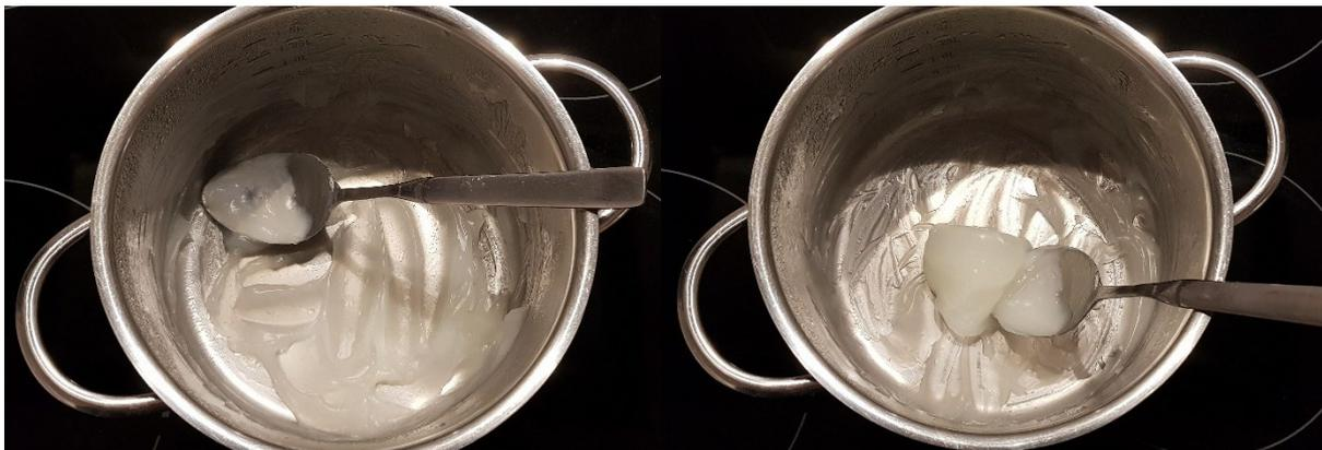
Abbildung 4: Flüssige Grundmasse des Kunststoffes nach ca. 25-30 Minuten Erhitzen. Die Masse sollte leicht durchscheinend sein, sodass der Topfboden zu erkennen ist (links). Die Masse sollte gelartig und formbar sein (rechts).
